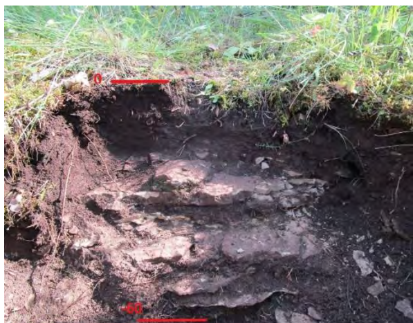
Fotod 17,18. Šurf 3, vana paemurru kaguservas, 15 cm kamarakihi all paljanduvad kuni 1 m sügavuseni murtud paekihid, vaade loode poolt
