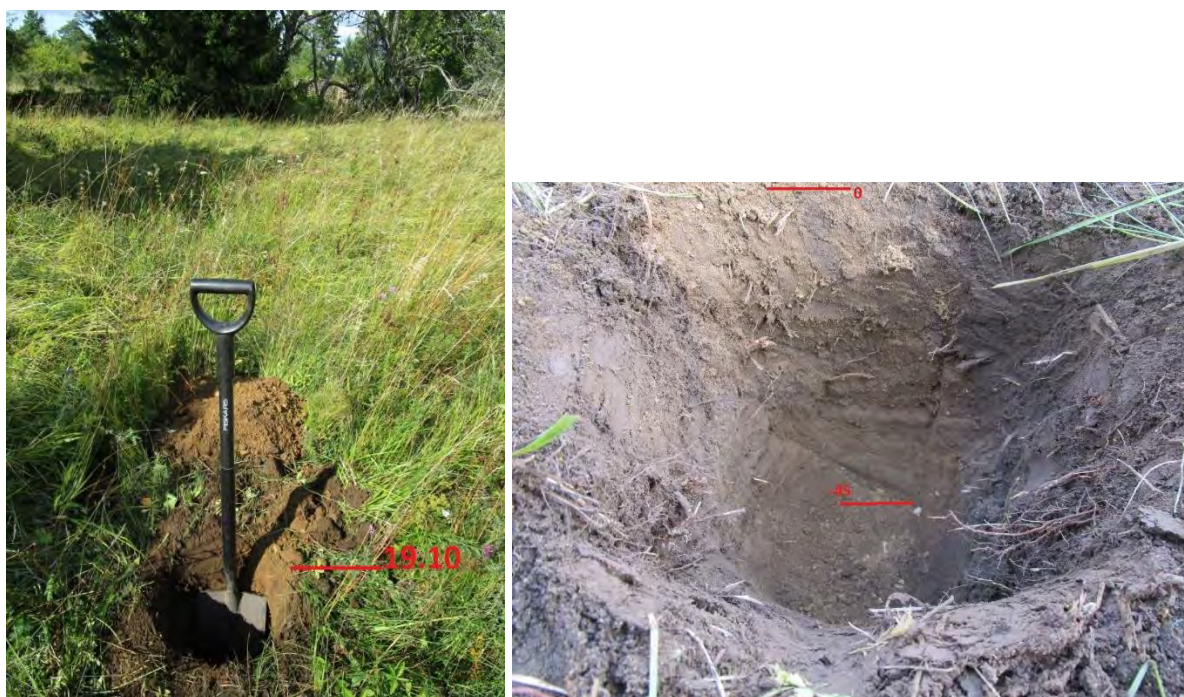
Fotod 15,16. Šurf 2, mättakihi all pruun saviliiva kiht paealuspõhjani 45 cm sügavusel, vaade kagu poolt
