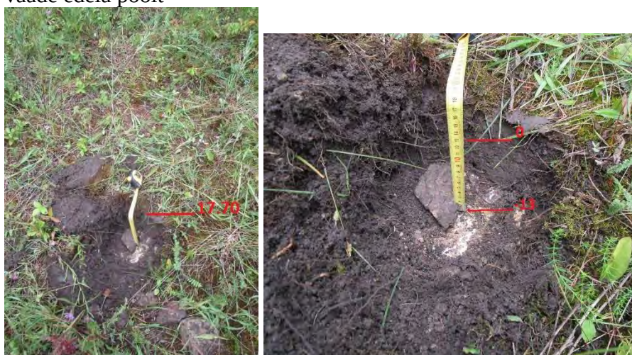
Fotod 25, 26. Šurf 8, 13 cm paksune kamara- ja kasvumulla kiht pae peal, vaade põhja poolt
