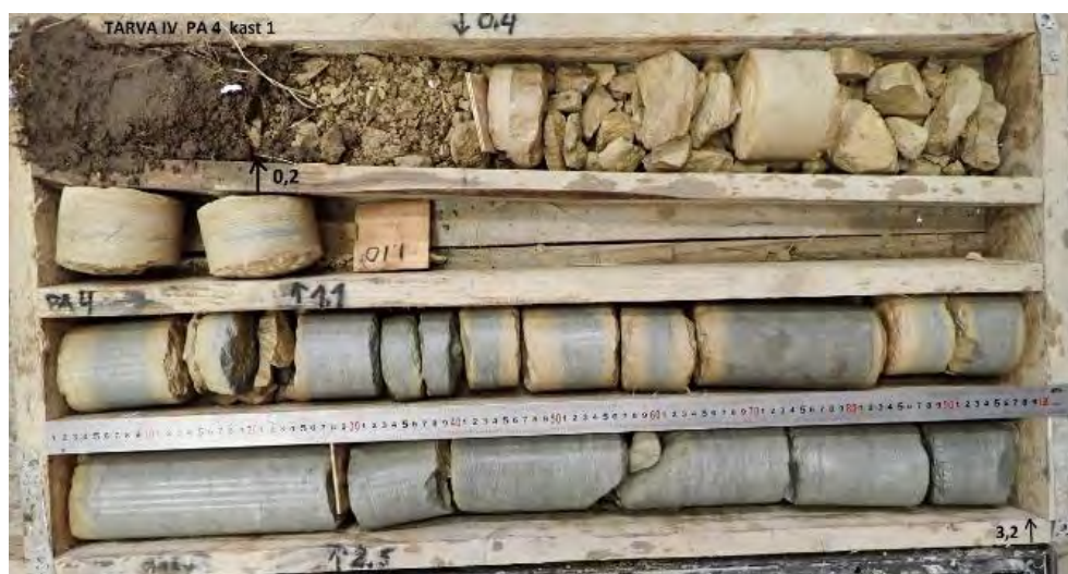
Joonis 13a. Puurangu 4 läbilõike ülemine osa. Kasti servadel märgitud numbrid tähistavad sügavust maapinnast. OÜ Inseneribüroo STEIGER
