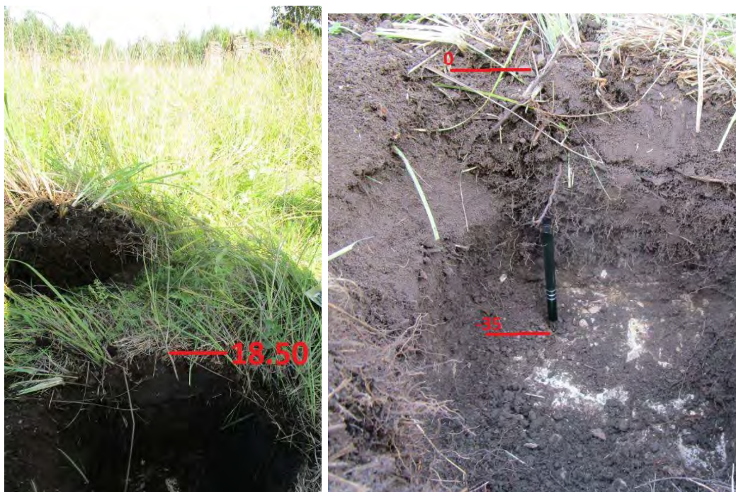
Fotod 13,14. Šurf 1, mättakiht ja kamaraalune ühtlane mullakiht paealuspõhjani 35 cm sügavusel ümbritsevast maapinnast absoluutkõrgusel 18.50 ümp, vaade põhja poolt, tagaplaanil paest lauda vare
