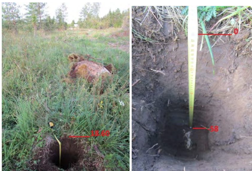
Fotod 21,22. Šurf 6 põllumaa ja paemurru piiril. Kiviaia servale, ülekäigukoha kõrvale kuhjunud pruunikas kamara ja mullakiht on kuni 55 cm paksune, selle all paepõhi, vaated edela ja lõuna poolt
