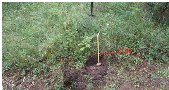
Fotod 27,28. Šurf 9, 15 cm paksune ühtlane tumepruun mullakiht madalama kuhjatise lõunaservas paealuskihi peal, vaade põhja poolt
