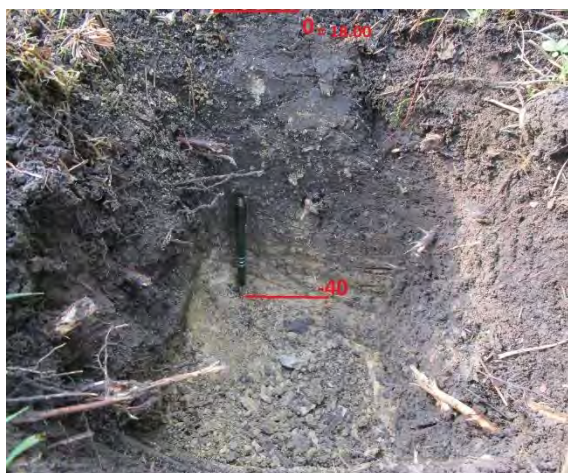
Foto 20. Šurf 5, 20 cm mullakihi all asub u 20 cm paksune osaliselt segatud mulla ja saviliiva üleminekukiht kuni ühtlase paepõhjani, vaade lõuna poolt
